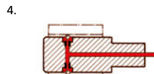
4. Měření průměrů průchozích otvorů s hlavicí s kuličkovými kontakty
