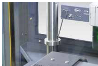
Měření dotkovou metodou s T7W
